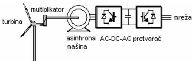
Sl. 1. Pogon puno-upravljanog vetrogeneratora sa asinhronom mašinom
