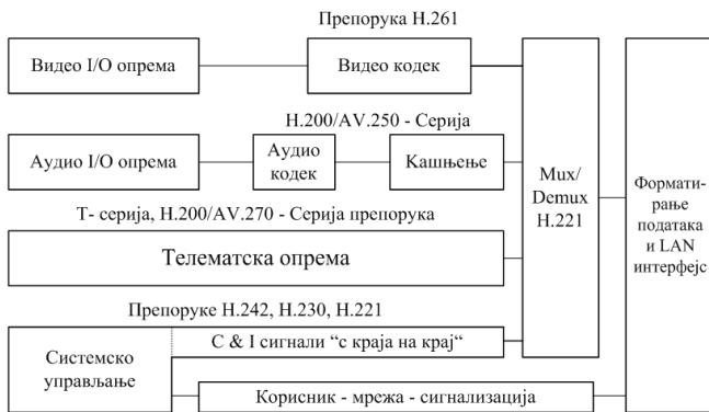
Сл. 2 – Блок шема структуре H.322 мултимедијалног терминала
