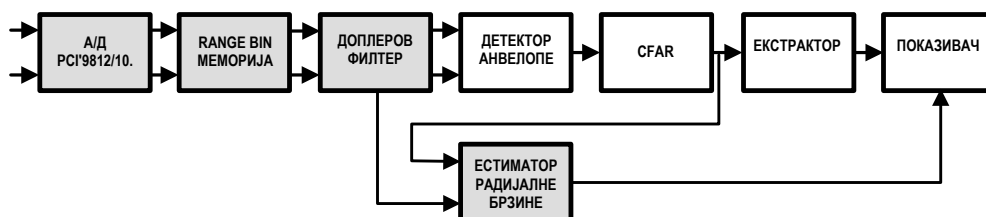
Сл. 7. Блок шема софтверског радарског пријемника
