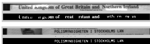
Сл. 7. Редови ван MRZ-a у којима постоји велики број региона који задовољавају задате димензије
