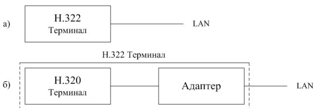
Сл. 3 – Алтернативна решења H.322 мултимедијалног терминала
