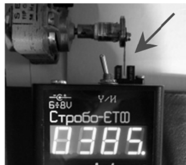
Слика 13. Импулсно мјерење брзине обртања.
