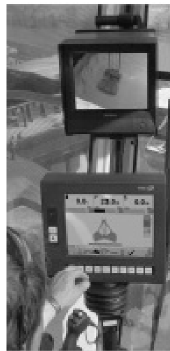
Sl.6 Vizualni nadzor operacija transporta putem kamera i SCADA sistema
