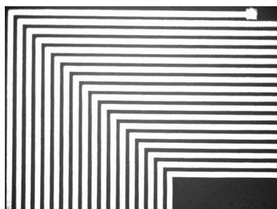
Сл. 7. Увећани део проводних линија индуктора фабрикованог сензора силе.
